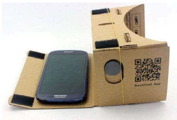
Рис. 5. Картонный шлем виртуальной реальности на базе смартфона
